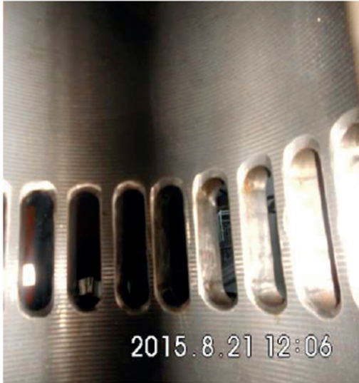
Şekil 9. Yeni Silindir Layner (Solda) ve Eski Silindir Layner (Sağda) yüzeyleri
