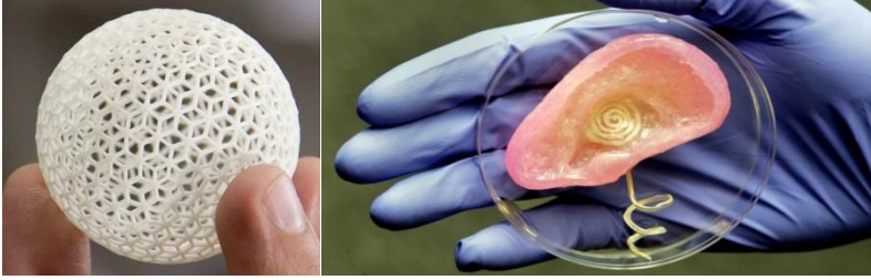
Şekil 1. Katmanlı İmalat ile Üretilmiş İç İç Geçmiş Delikli Küreler ve Canlı Doku Üretimi.
