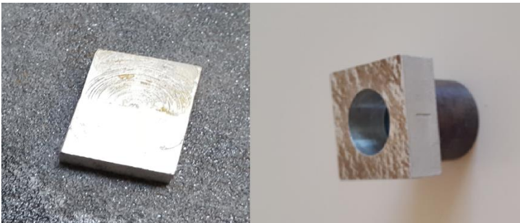
Şekil 3.2. Mikro Yapı-Sertlik İncelemesi için Hazırlanan Numune ve RAM Çekme Testi Numunesi
