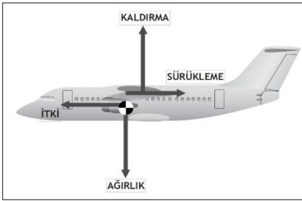
Şekil 1. Üstten Kanatlı Bir Hava Aracına Etki Eden Dört Kuvvet.
